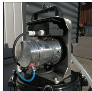
Probenahmemodul in der non Ex-Version mit kleinem Li-Ionen Akku
