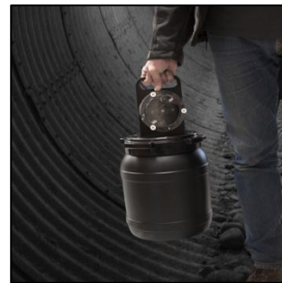
Im Schacht installiertes Probenahmemodul in der Ex-Version
